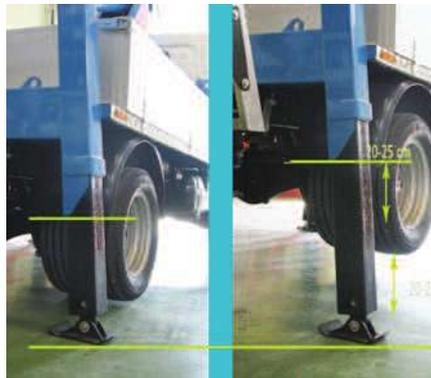
3. Facilita el uso de planchas de apoyo en superficies irregulares o pendientes, el descenso de los estabilizadores no desplaza las planchas de apoyo dificultando su uso. La SOCAGE T318 forSte incorpora de serie las planchas de apoyo que son de gran utilidad.
