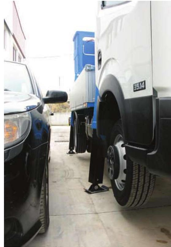
4. Este tipo de estabilización permite estabilizar la máquina en un área muy reducida (no sobresalen los estabilizadores del vehículo). La estabilización SOCAGE ME+H es ideal para calles muy estrechas, zonas de mucho tráfico, trabajos en doble fila y superación de obstáculos urbanos.
